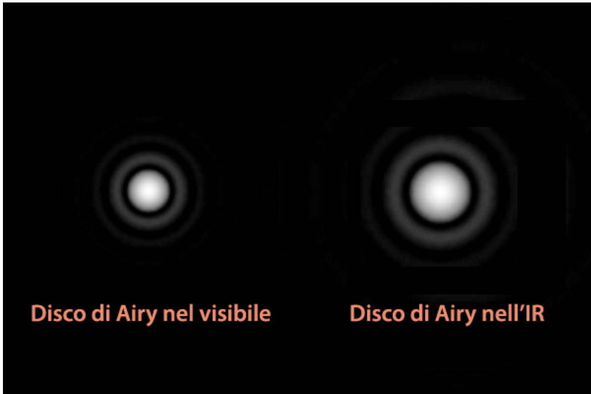
Disco di Airy risultante dalla media dei valori nel visibile e nell'IR
